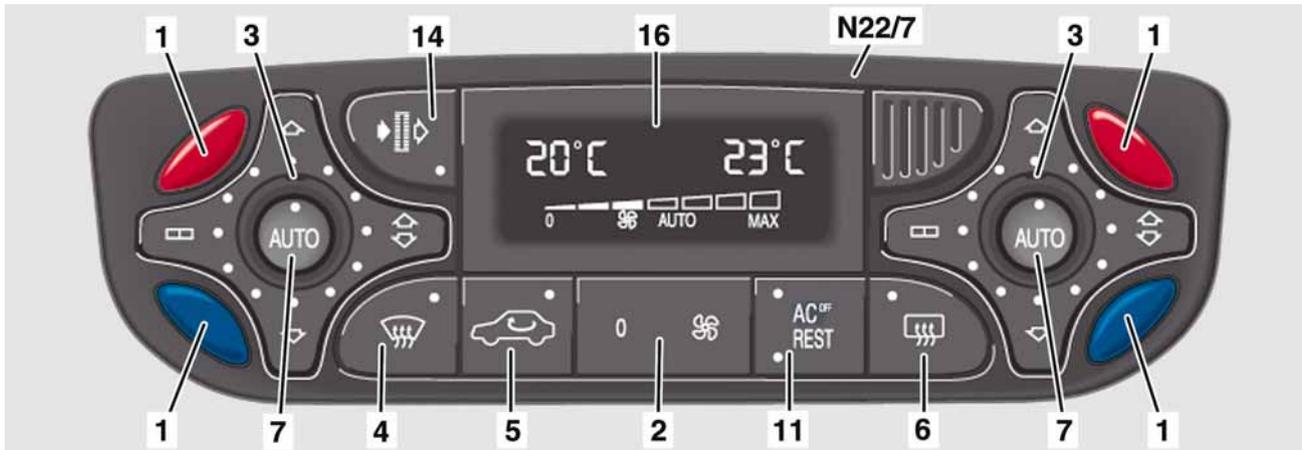
Clavier et calculateur pour KLA confort (N22/7)
