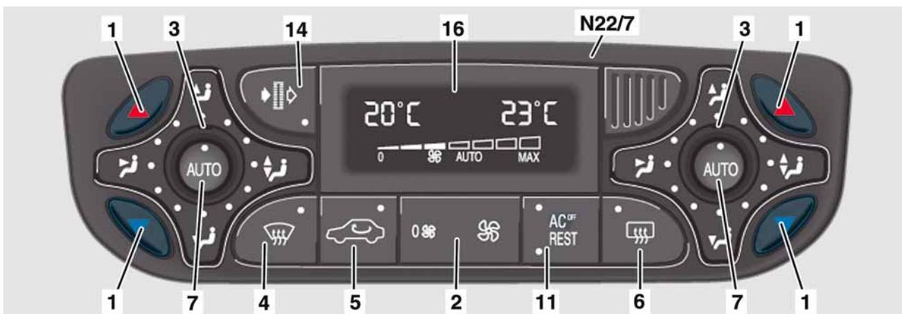
Clavier et calculateur pour KLA confort (N22/7)
