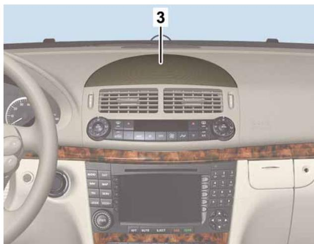
**Buse de cockpit (3) avec tôle perforée**
