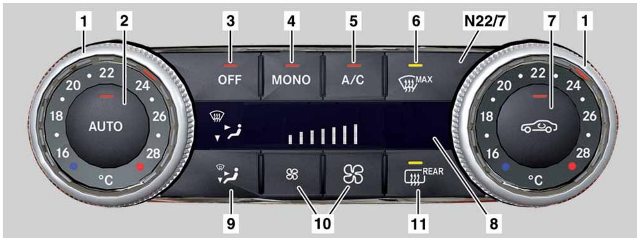
Calculateur et clavier climatiseur automatique (N22/7)
