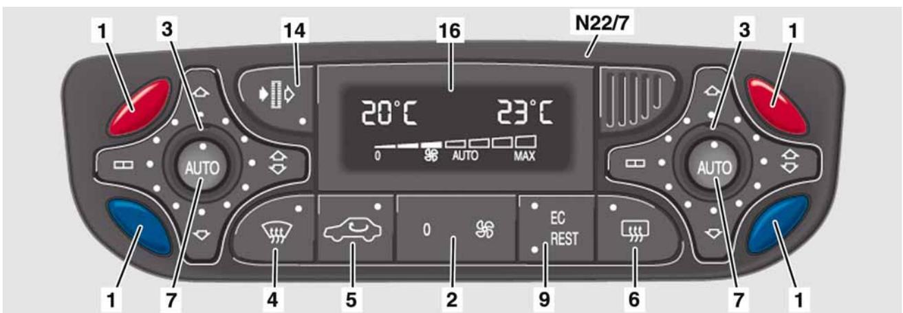
Clavier et calculateur pour KLA confort (N22/7)
