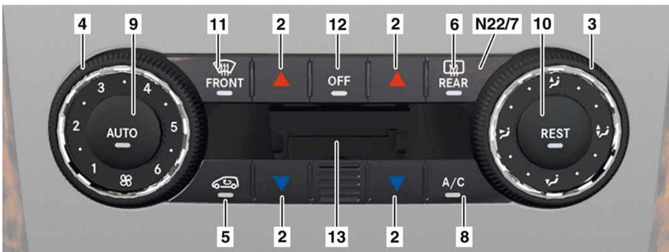
Clavier et calculateur pour KLA confort (N22/7)
