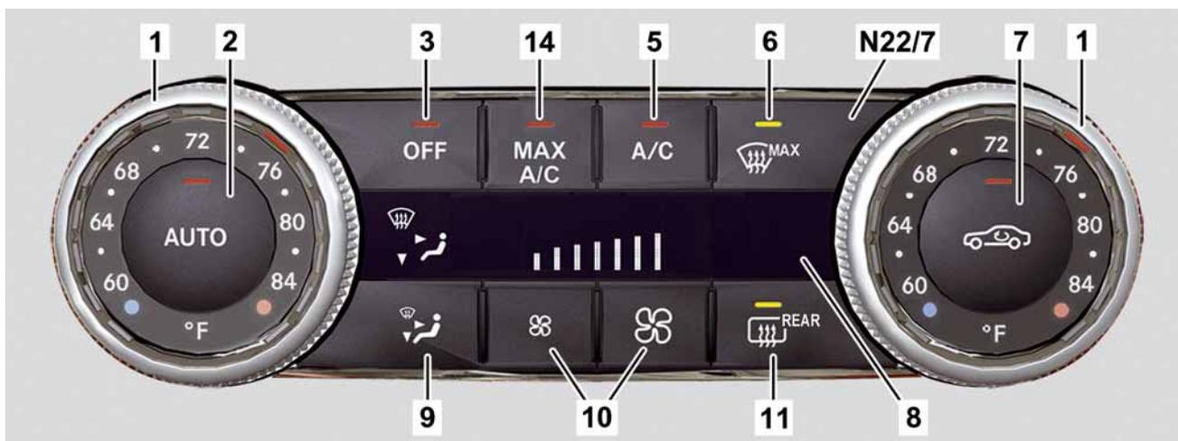
Calculateur et clavier climatiseur automatique (N22/7)
